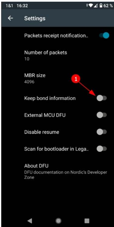
Dort ist nun „Keep bond information“ abzuschalten. Diese Funktion ist hilfreich, um ein bereits erkanntes Gerät schneller verbinden zu können. Das „reelboard“ jedoch ist nach jedem Einschalten nur mit einer neuen MAC-Adresse erreichbar. Daher würde in der App jede neue Verbindung automatisch einen Eintrag für ein neues Gerät erzeugen und die Liste unnötig verlängern und unübersichtlich machen.
