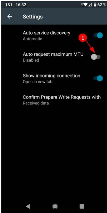
Im folgenden Fenster ist 1.) „Auto request maximum MTU“ einzuschalten. Das „reelboard“ empfängt in der Standardeinstellung nur 23 Zeichen. Das ist für unsere Anwendung zu wenig. Hier wird der Empfangspuffer auf maximale Größe 517 gesetzt. Das ist für unsere Zwecke mehr als ausreichend. Hier links im Bild ist der maximale Wert noch ausgeschaltet.
