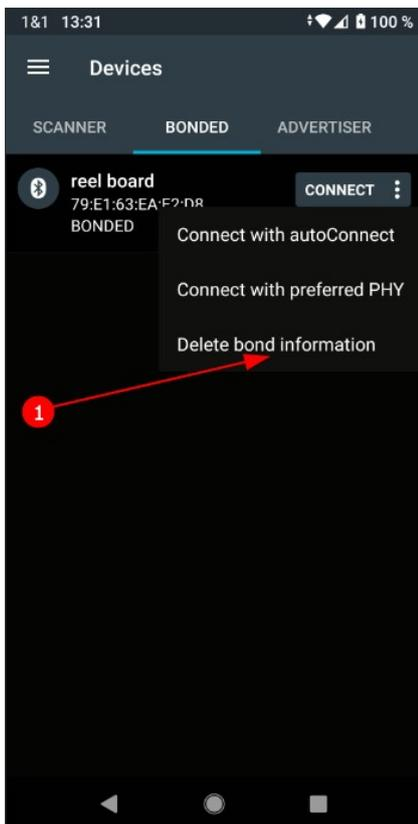
Dort unter 1.) „Delete bond information“ betätigen. Damit löst man die gespeicherte Geräteverbindung, da das „reelboard“ ja bei jedem Einschalten eine neue MAC-Adresse hat.
